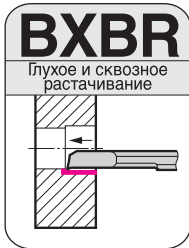
Рис. 1 (показана вставка со стружколомом)
