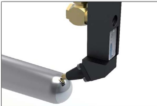
Обработка пуансона инструментом HG6
