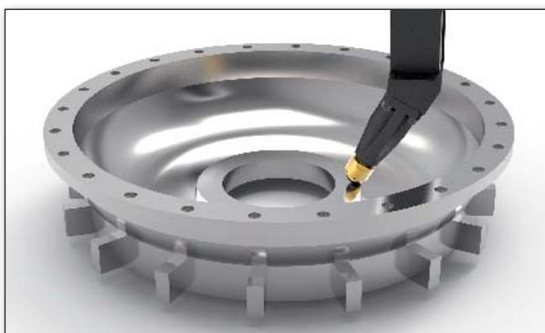
Обработка корпуса конвертера инструментом HG13
